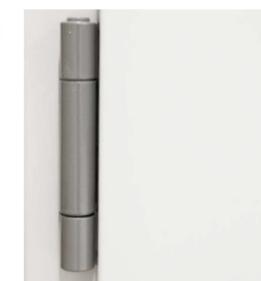
Unsere dreidimensional verstellbaren Türbänder ermöglichen eine Höhen-, Seiten- und Andruckverstellung ohne Aushängen der Tür.
